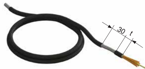
Imagem 25 Desnudar 30 mm do cabo CEM antes da ligação à placa de bornes do cabo. Dimensão "t" correspondente à distância aproximada da braçadeira de fixação ao fixador de cabos
