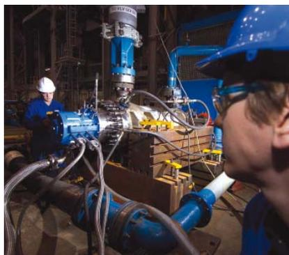
Модернизированный насос на испытаниях.
