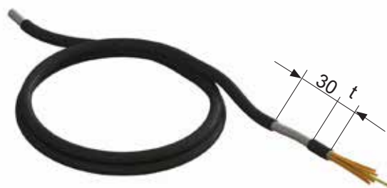
Joonis 25 Eemaldage EMC kaabli isolatsioon enne klemmiplaadile kinnitamist 30 mm pikkuselt. Mõõt „t“ on umbes vahemik kinnitusklambrist kaabliklemmini
