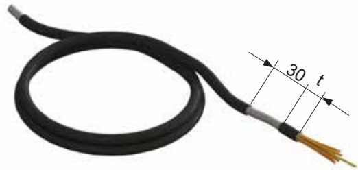
Fig. 25 Spelare il cavo CEM di 30 cm prima del collegamento alla morsetteria. La misura "t" corrisponde alla distanza approssimativa della fascetta di fissaggio dal morsetto.
