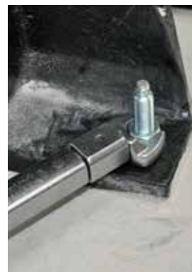
Afb. 9d Moer aandraaien
